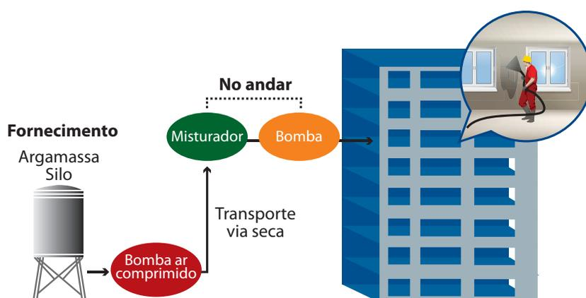
Após a preparação da argamassa, a sua aplicação na parede é efetuada por meio de projeção, adotando, a partir desse ponto, equipamentos portáteis de projeção de distâncias curtas, similares ao que está detalhado no item 2.3, a seguir.
